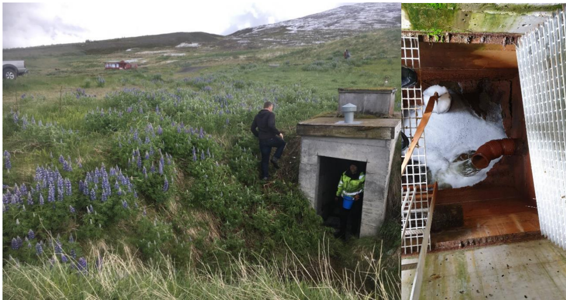
Mynd 2. Mælistaður P-0 (Brunnur). Hægri mynd: hné hafði verið sett á afrennslsrörið í brunninum þegar mælingar voru gerðar þann 16. júní 2021. Fata var látin síga ofan brunninn og sýni tekið úr vatninu sem rann úr rörinu. Hitastig og pH-gildi var svo mælt á sýninu.
