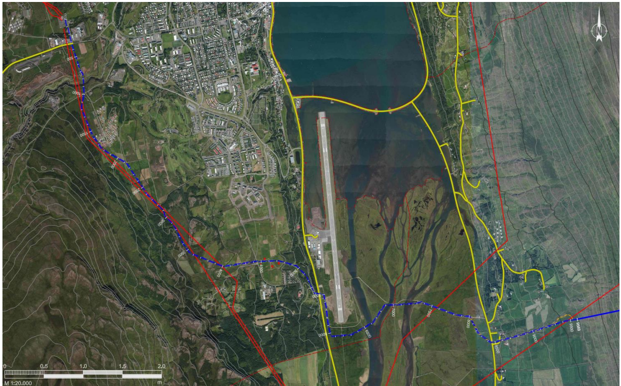
MYND 3.1 Yfirlitsmynd af framkvæmdarsvæði. Núverandi loftlínur eru sýndar rauðar og nýr jarðstrengur sýndur blár.
