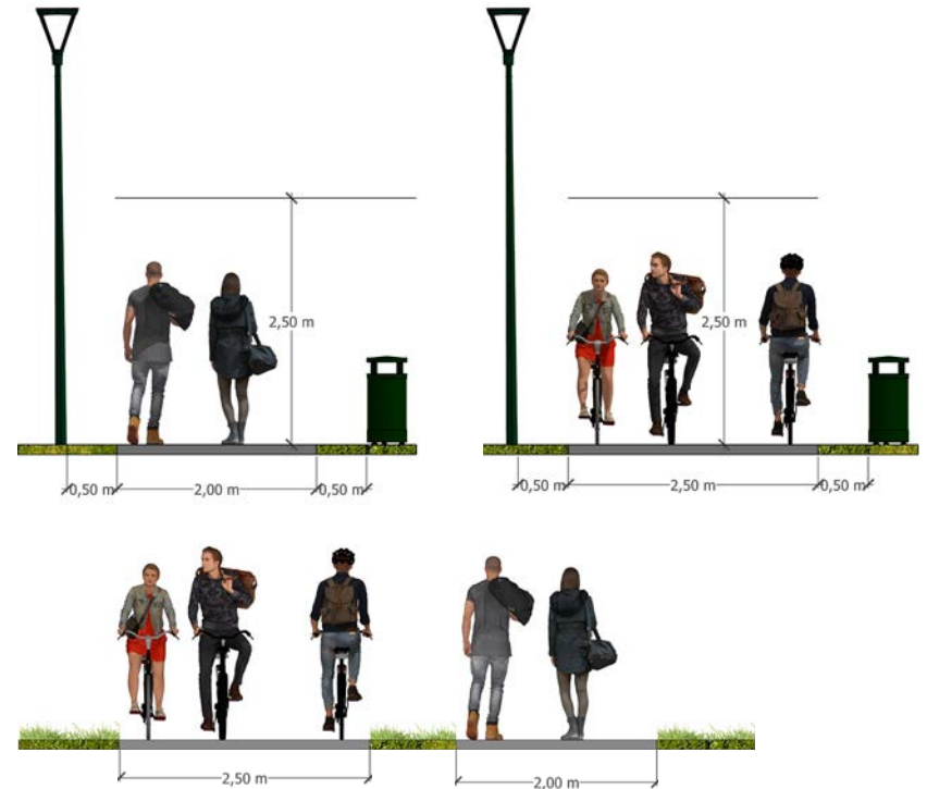
Mynd 31.17-19 Snið með lágmarksstærðum á aðskildum göngu- og hjólastígum.
