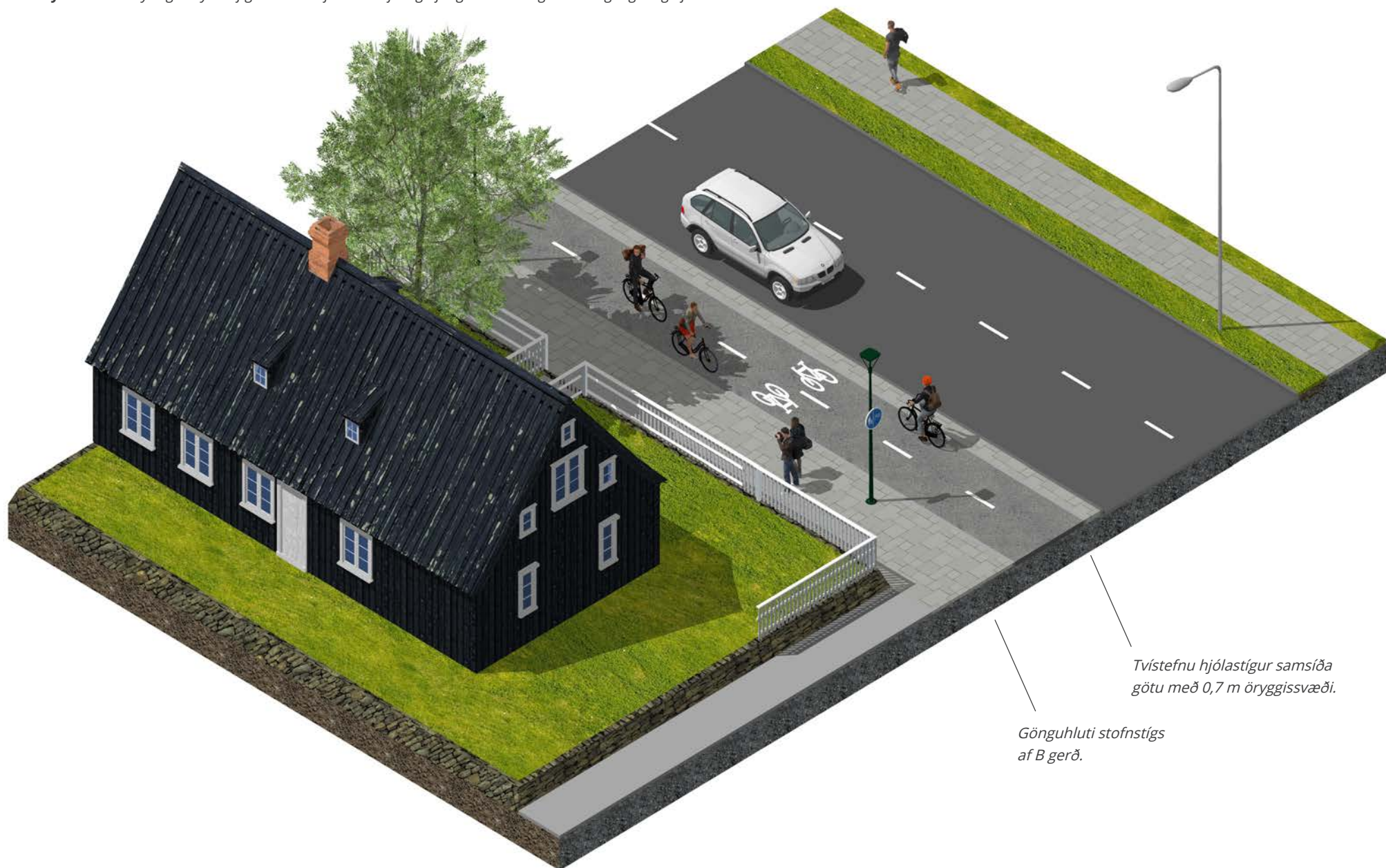
Mynd 31.16 Skýringarmynd af götuumhverfi með stofnstíg af B gerð með aðgreindum göngu- og hjólahluta.
