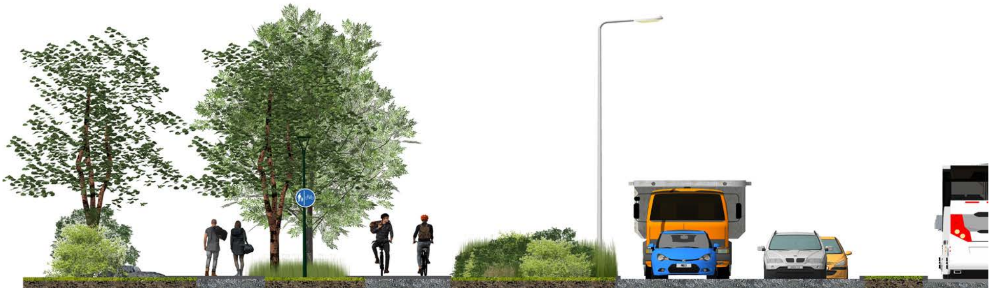
Mynd 31.20 Snið af C gerð stofnstíga með aðskildum göngu- og hjólastígum. Gróðurbelti aðskilur stígana frá umferðarþungri götu.
